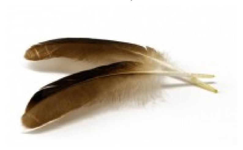
La laine à base de plumes de canard est fabriquée en rouleaux, en panneaux ou en vrac, elle peut être utilisée en isolation thermique des bâtiments : combles perdus, rampants, sous plancher, plafond et murs.
